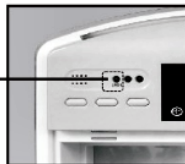
A HEPA-szűrő cseréjére figyelmeztető LED
