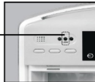
A rostsűrő cseréjére figyelmeztető LED
